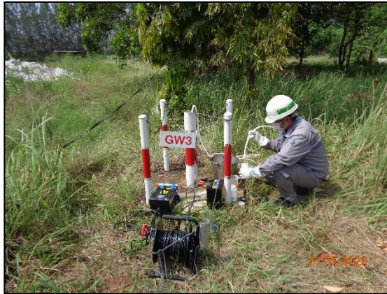
รูปที่ 3.14 การเก็บตัวอย่างคุณภาพน้ำใต้ดิน บริเวณ บริเวณพื้นที่สีเขียวท้ายโรงหลอม 1 (GW3)
