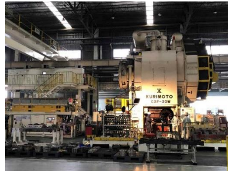
ระบบทำงานด้วยการลำเลียงชิ้นงานแบบอัตโนมัติ (Automatic transfer)
