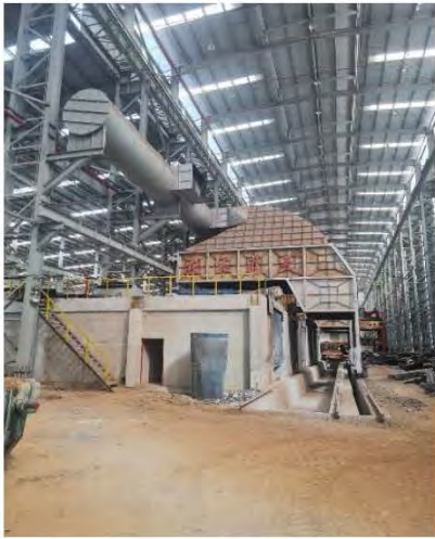
ภาพที่ 3.1 ระบบรวบรวมฝุ่น (Hood)
