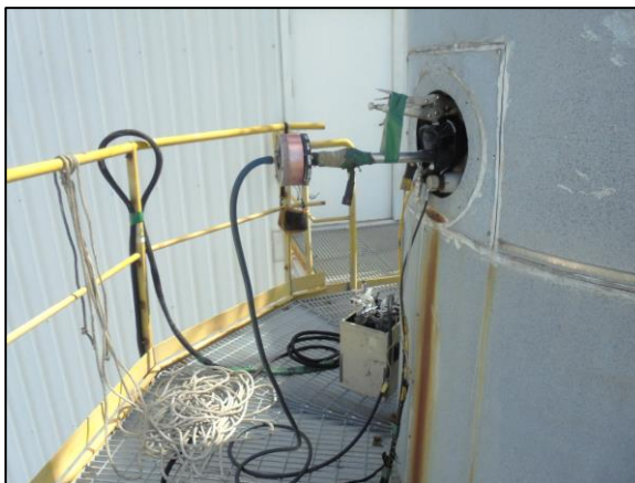
รูปที่ 3.2 การเก็บตัวอย่างคุณภาพอากาศในปล่องระบาย บริเวณ Furnace Stack MCL2 (S8)
