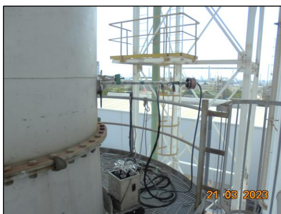
รูปที่ 3.1 การเก็บตัวอย่างคุณภาพอากาศในปล่องระบาย บริเวณ Furnace Stack MCL1 (S4)
