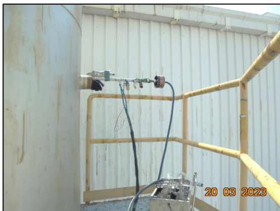
รูปที่ 3.8 การเก็บตัวอย่างคุณภาพอากาศในปล่องระบาย บริเวณ Cold Mill Stack CRM (S2)
