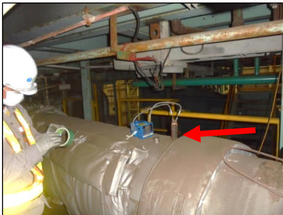
รูปที่ 3.5 การเก็บตัวอย่างคุณภาพอากาศในปล่องระบาย บริเวณ Inline Painting Stack MCL1 (S6)
