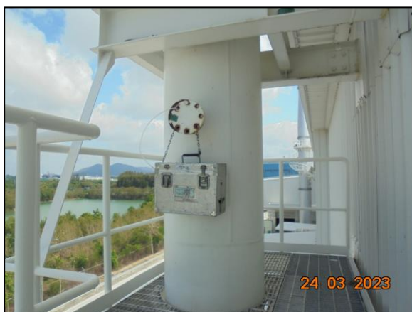
รูปที่ 3.18 การเก็บตัวอย่างคุณภาพอากาศในปล่องระบาย บริเวณ Cleaning Fume Exhaust Scrubber Stack MCL 3 (S15)
