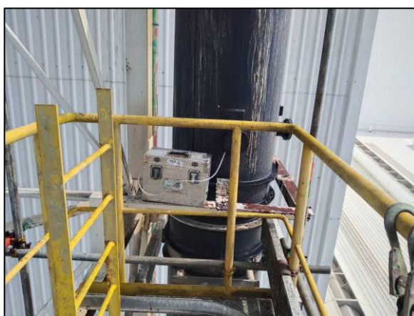
รูปที่ 3.10 การเก็บตัวอย่างคุณภาพอากาศในปล่องระบาย บริเวณ Alkali Cleaning Stack MCL2 (S7)
