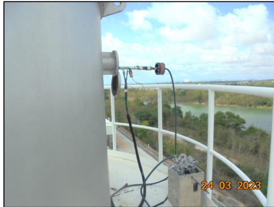
รูปที่ 3.15 การเก็บตัวอย่างคุณภาพอากาศในปล่องระบาย บริเวณ Furnace Stack MCL 3 (S16)
