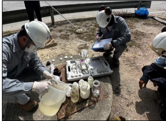
รูปที่ 3.24 การเก็บตัวอย่างคุณภาพน้ำทิ้ง บริเวณบ่อน้ำทิ้งหลังผ่านระบบบำบัดน้ำเสียของโครงการ (Ww)
