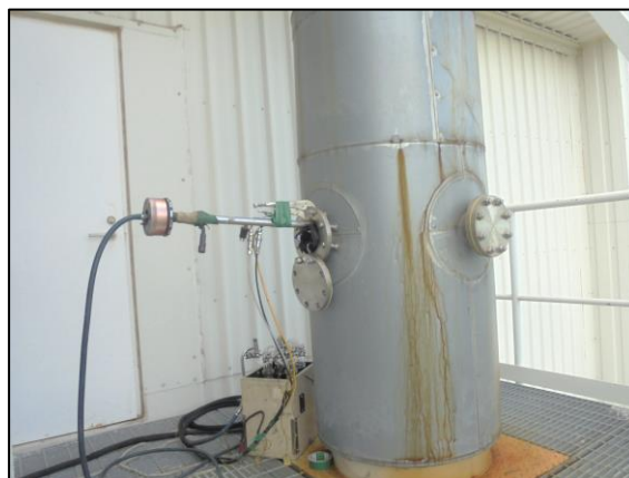
รูปที่ 3.16 การเก็บตัวอย่างคุณภาพอากาศในปล่องระบาย บริเวณ Oven Stack MCL 3 (S17)
