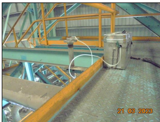
รูปที่ 3.9 การเก็บตัวอย่างคุณภาพอากาศในปล่องระบาย บริเวณ Alkali Cleaning Stack MCL1 (S3)
