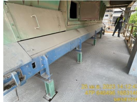
รูปที่ 14 การตรวจสอบปริมาณฝุ่นสะสม บริเวณ Hopper หรือ Conveyors
