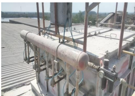
รูปที่ 9 การเปลี่ยนและตรวจสอบถุงกรอง
