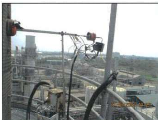
ภาพถ่ายที่ 3.5.1.2-1 ขณะดำเนินการตรวจวัดคุณภาพอากาศจากปล่อง HRSG#2 (CTG#2)
