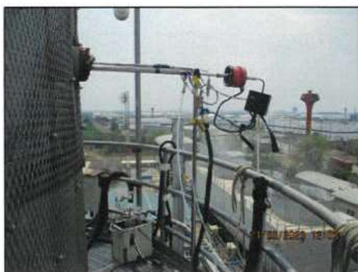
ภาพถ่ายที่ 3.5.1.1-1 ขณะดำเนินการตรวจวัดคุณภาพอากาศจากปล่อง HRSG#1 (CTG#1)
