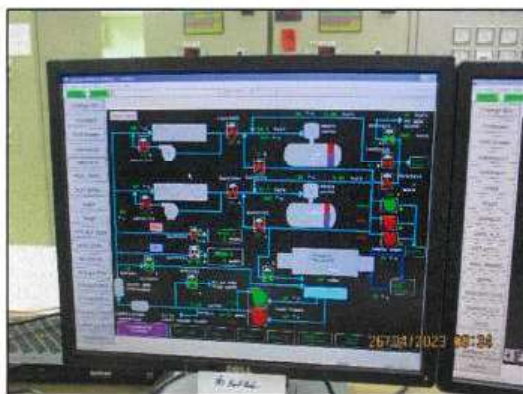
ภาพถ่าย 2.2-15 ระบบเตือนให้พนักงานปิดวาล์วระบายน้ำทิ้ง
