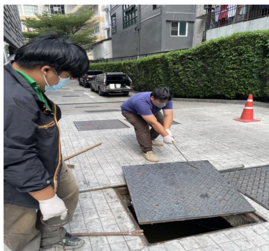
น้ำก่อนระบายออกนอกโครงการ ภาพที่ 3.5.3-1 การเก็บตัวอย่างน้ำระบบบำบัดน้ำเสีย
