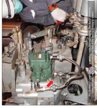
รูปภาพที่ 2 แสดงตำแหน่งการติดตั้ง Governor และท่อน้ำมันที่เกี่ยวข้อง
