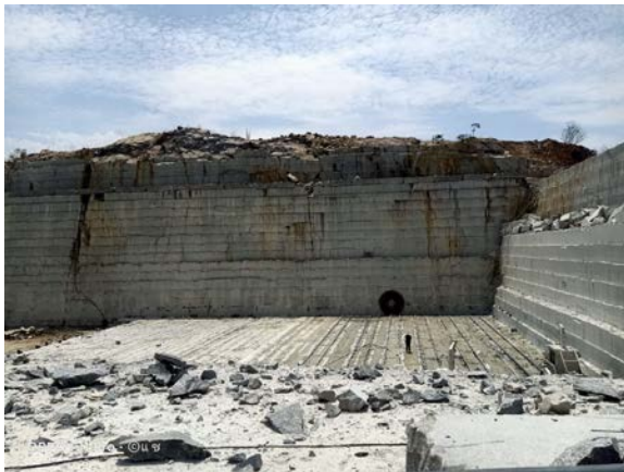
รูปที่ 2-1 การผลิตแร่โดยใช้เลื่อยยนต์และการเจาะแบ่งด้วยลิ้ม
