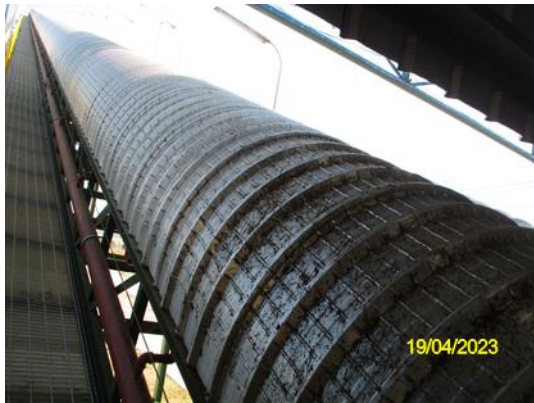
รูปที่ 15 ระบบสายพานลำเลียงเชื้อเพลิงจากอาคารป้อนเชื้อเพลิงไปยังหม้อไอน้ำ (ระบบปิดครอบ)
