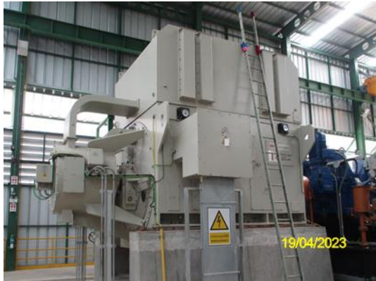
รูปที่ 25 การปิดครอบอุปกรณ์เครื่องจักรที่มีเสียงดัง
