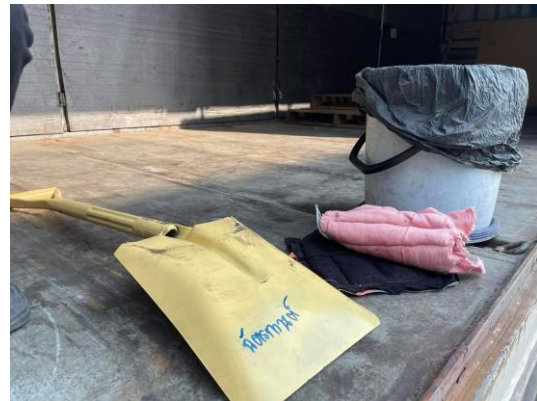
รูปที่ 39 อุปกรณ์ระงับเหตุฉุกเฉินประจำรถขนส่งสารเคมี
