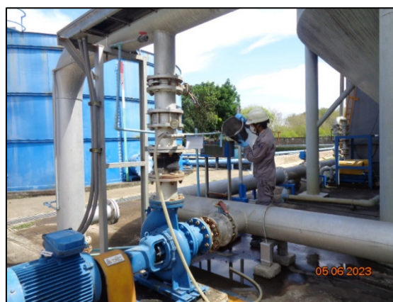
รูปที่ 3.2 การเก็บตัวอย่างคุณภาพน้ำทิ้งจากระบบบำบัดน้ำเสีย SBR บริเวณ TW 2 (ถังตกตะกอน)
