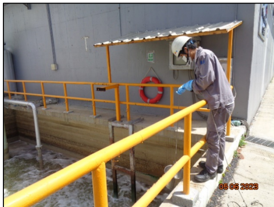
รูปที่ 3.1 การเก็บตัวอย่างคุณภาพน้ำเสียจากระบบบำบัดน้ำเสีย SBR บริเวณ TW 1 (ถังปรับเสมอ)
