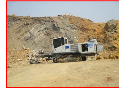
(14) รถเจาะที่มีเครื่องดูดฝุ่นบริเวณหัวเจาะ
