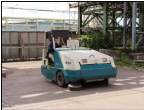
ภาพที่ 2.7 รถดูดฝุ่นและพ่นกาวทำความสะอาดพื้นถนนบริเวณเส้นทางขนส่งวัตถุดิบ
