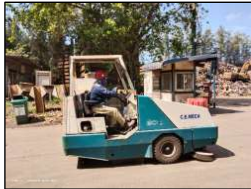
ภาพที่ 2.7 รถดูดฝุ่นและพ่นกาวทำความสะอาดพื้นถนนบริเวณเส้นทางขนส่งวัตถุดิบ
