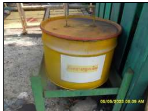
ภาพที่ 2.14 ถังทรายที่ใช้ดูดซับสารเคมีภายในโครงการ กรณีสารเคมีหกหรือรั่วไหล
