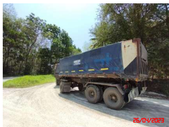
รูปที่ 9 การใช้ผ้าใบปิดคลุมกระบะรถบรรทุก
