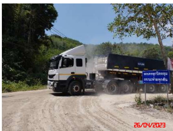
รูปที่ 9 การใช้ผ้าใบปิดคลุมกระบะรถบรรทุก
