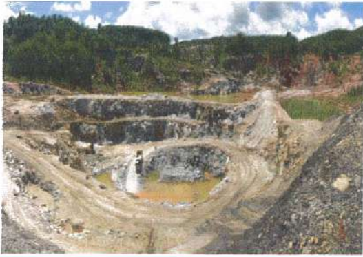
รูปที่ 1 พัฒนาหน้าเหมืองเป็นแบบขั้นบันได
