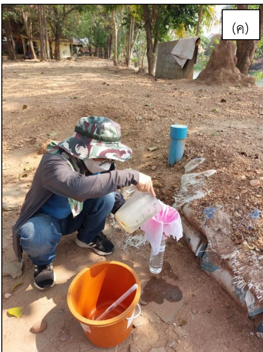
รูปที่ 5.1.4-9 การสำรวจ และเก็บตัวอย่างน้ำ บ่อสังเกตการณ์ (ค) และบ่อบาดาลจากประปาหมู่บ้าน (ง)
