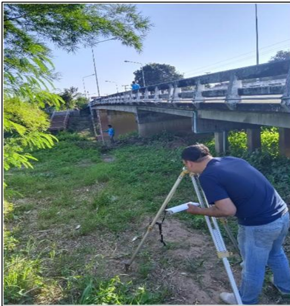
รูปที่ 5.2.2-10 สํารวจรูปตัดขวางลำน้ำและสํารวจปริมาณน้ำ สถานี E.5 แม่น้ำชี บ้านโนนเปลือย ต.ตลาดแร้ง อ.บ้านเขว้า จ.ชัยภูมิ
