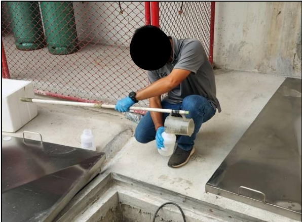
จุดเก็บตัวอย่างน้ำทิ้งที่บ่อพักน้ำทิ้งสุดท้าย (ก่อนระบายออกท่อระบายน้ำสาธารณะภายนอกโครงการ)
