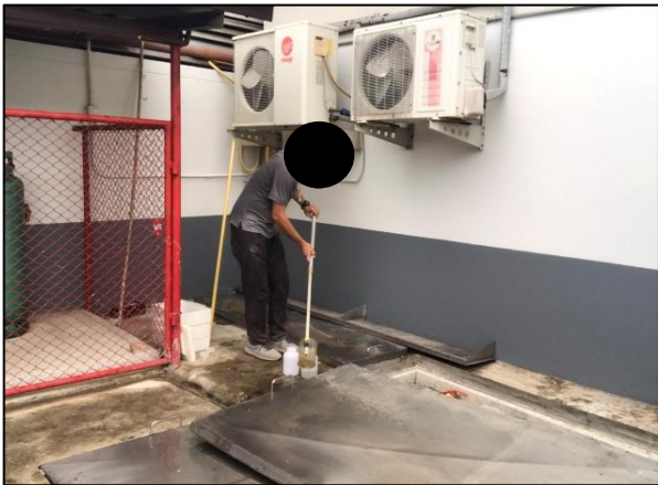
จุดเก็บตัวอย่างน้ำทิ้งที่บ่อพักน้ำทิ้งสุดท้าย (ก่อนระบายออกท่อระบายน้ำสาธารณะภายนอกโครงการ)
