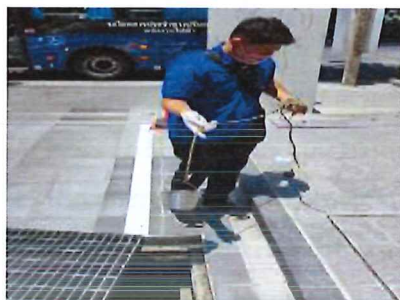
ภาพที่ 3.5.1-1 การเก็บตัวอย่างน้ำบริเวณบ่อพักน้ำสุดท้ายก่อนระบายออกนอกโครงการ
