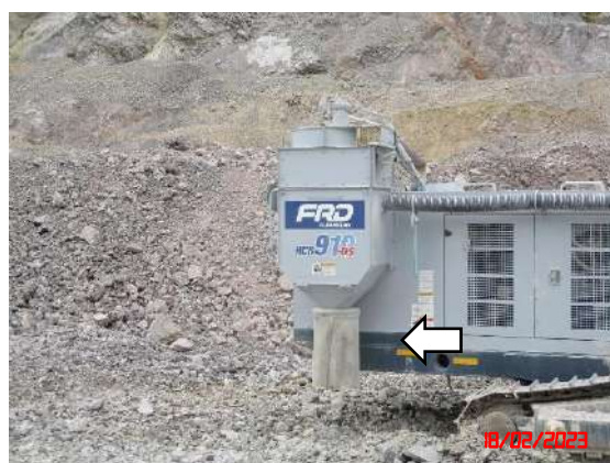
รูปที่ 22 เครื่องเจาะระเบิดที่มีอุปกรณ์เก็บฝุ่น
