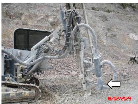
รูปที่ 22 เครื่องเจาะระเบิดที่มีอุปกรณ์เก็บฝุ่น
