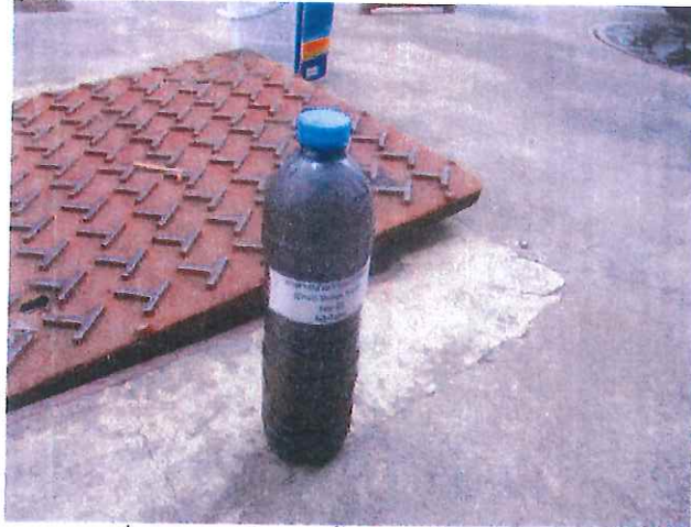
ภาพที่ 2 แสดง ตัวอย่างน้ำบ่อพักน้ำเสีย (EQ Tank)
