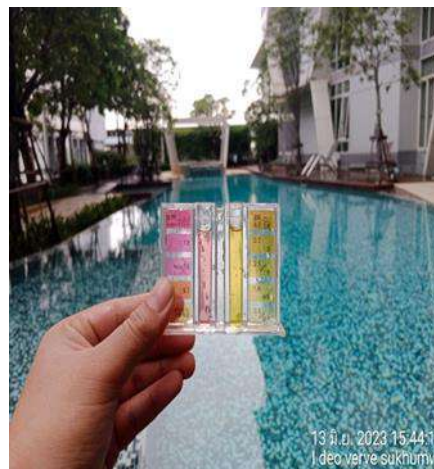
ภาพที่ 4.6.2 การตรวจวัด pH และ Free Chlorine สระว่ายน้ำ
