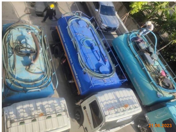
รูปที่ 2-15 ประสานงานกับรถสูบสิ่งปฏิกูลของเอกชน เพื่อสูบไขมันของระบบบำบัดน้ำเสียไปกำจัดต่อไป
