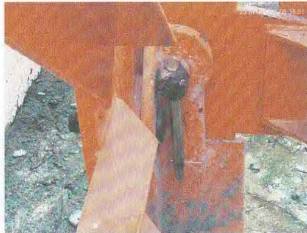
ชุดสลักยึดโครงสร้างหลักกลีปล็อก 3 จุด
