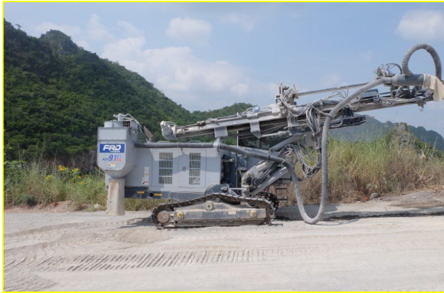
ภาพที่ 2-8 เครื่องเจาะรูระเบิดที่มีถังดักฝุ่นบริเวณหัวเจาะ
