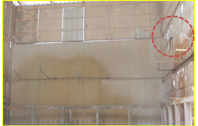
ภาพที่ 2-12 โรงโม่หินของโครงการปิดคลุม 3 ด้าน และการฉีดสเปรย์น้ำบริเวณปากโรงโม่
