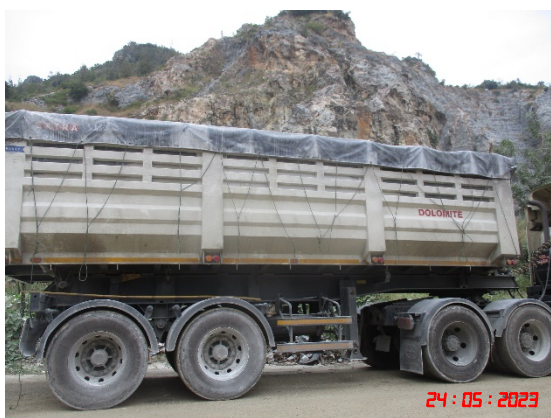
รูปที่ 6 การปิดคลุมกระบะรถบรรทุก
