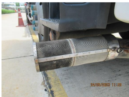
ภาพที่ 2-17 อุปกรณ์ดักจับลูกไฟติดกับท่อไอเสียรถยนต์
