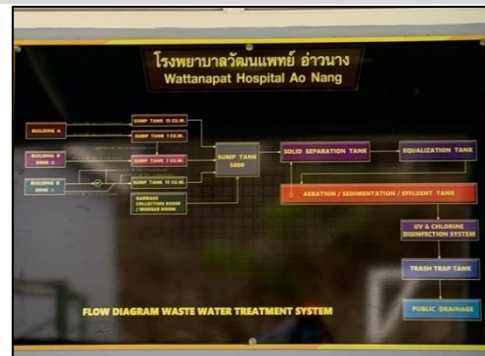
ไดอะแกรมระบบบำบัดน้ำเสียรวม
