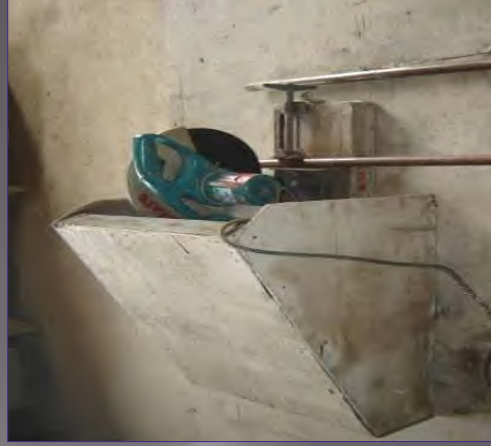
เครื่องตัดเหล็กต้องมีการครอบและมีที่บังสะเก็ดไฟ
