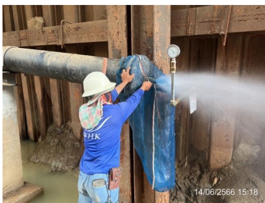
รูปที่ 3.2-24 การปรับแรงดันน้ำจากการทดสอบท่อ โดยวิธีชลสถิติ
