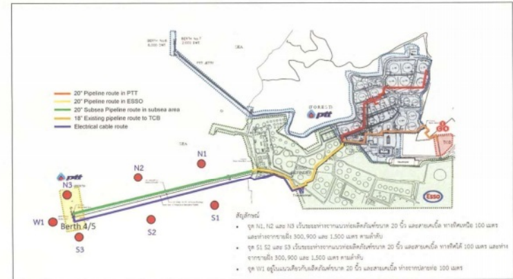
รูปที่ 7 จุดตรวจวัดความดันของน้ำระหว่างการวางท่อขนาด 20 นิ้ว และสายเคเบิลใต้ทะเลในบริเวณก่อสร้างของคลังน้ำมันศรีธรรมราช
