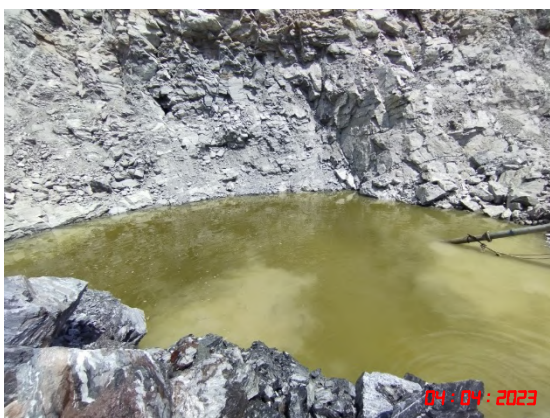
รูปที่ 5 บ่อรับน้ำฝน (Sump)
