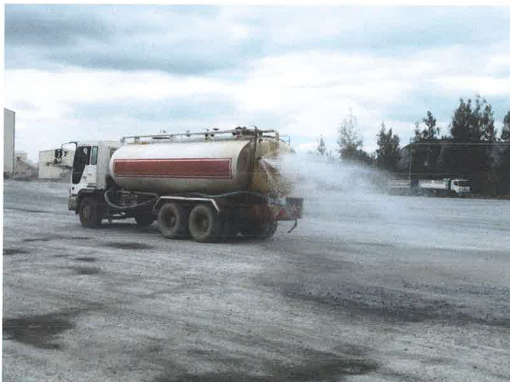
ภาพที่ ๑ : การนำน้ำจากบ่อพักน้ำดีักตะกอนมาใช้รดถนนและพื้นที่ต่างๆที่เกิดฝุ่นฟุ้งกระจาย
