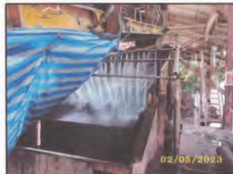
ระบบสเปรย์น้ำบริเวณตะแกรงสั่น
