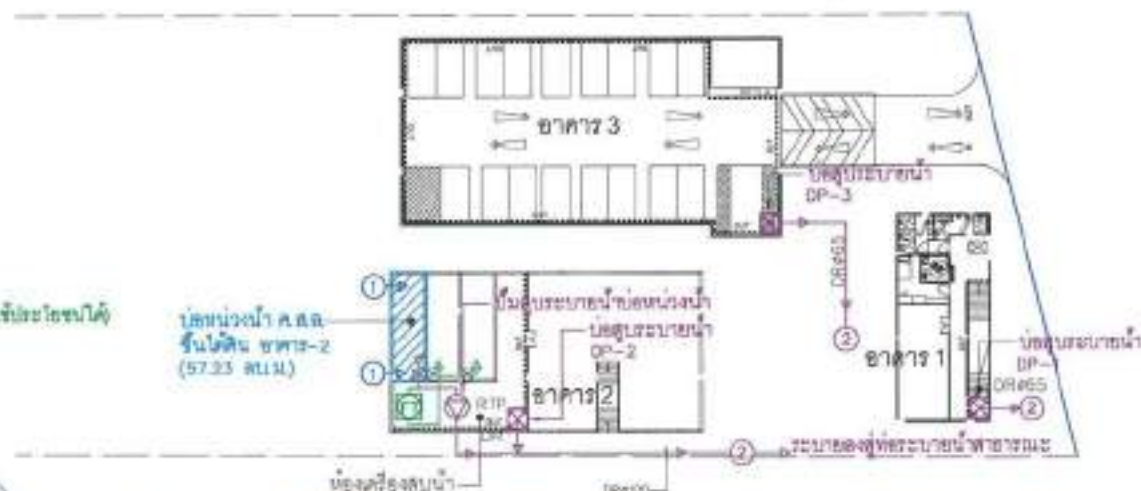
มีระบบระบายน้ำ ขึ้นได้ดิน (รวมมวลน้ำฝนจากหลังคาอาคารเข้าสู่อ่างน้ำใต้ดิน ส่วนที่ 2)
