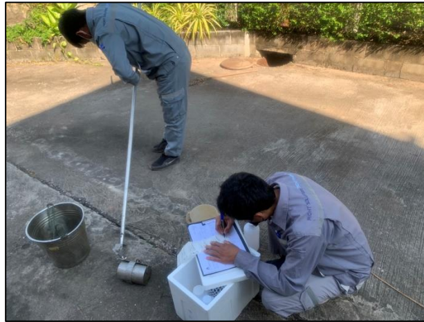
รูปที่ 3.1 การเก็บตัวอย่างน้ำทิ้ง บริเวณ จุดระบายน้ำทิ้ง (Effluent) วันที่ 3 พฤษภาคม 2566
