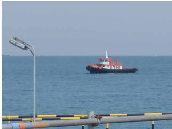
รูปที่ 2-15 เรือติดตั้งเครื่องฉีดน้ำและโฟมดับเพลิง เพื่อช่วยดับเพลิงเมื่อเกิดเหตุเพลิงไหม้บนเรือและทุ่นรับน้ำมัน และท่าเรือ
