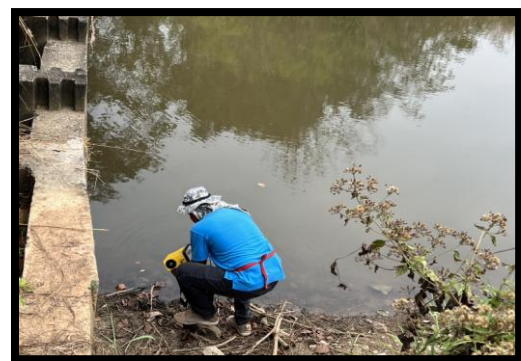
รูปที่ 2-6 การวัดกระแสน้ำลุ่มน้ำห้วยเสือ
