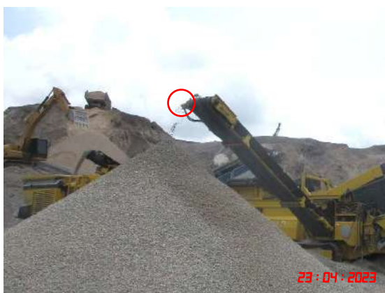
รูปที่ 24 ระบบเสาสเปรย์น้ำบริเวณเครื่องจักรอุปกรณ์ในการบด ย่อยหินแบบเคลื่อนที่ได้
