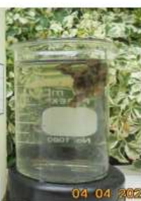
1.2 บ่อเกอระ จุดเก็บตัวอย่างน้ำเสียเข้าระบบ มีกากตะกอนสะสมอยู่ค่อนข้างมาก ควรเช็คความหนาแน่นของชั้นตะกอน เพื่อเตรียมการ สูบลากตะกอน ออกจากระบบบ้าง
