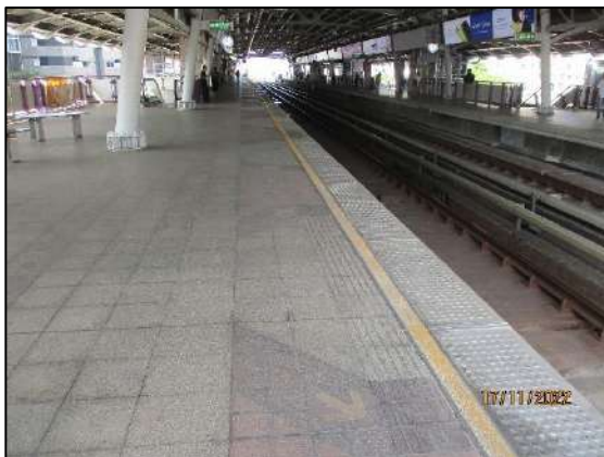
รูปที่ 2-17 แนวเส้นสีเหลืองและพื้นผิวขรุขระแสดงเขตห้ามล่ว่งล้อ
