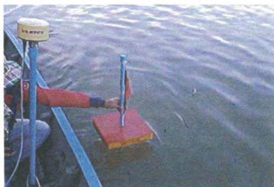
รูปที่ 3-14 ท่อนลอยสำหรับตรวจวัดกระแสน้ำและทิศทาง
