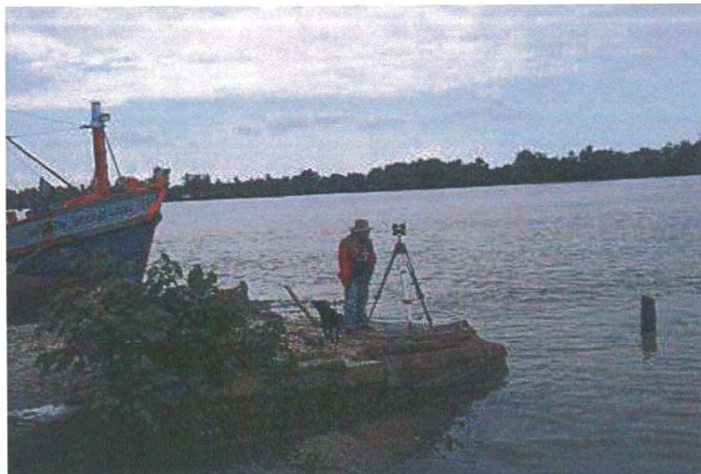
รูปที่ 3-19 การตรวจวัดความเร็ว และทิศทางของกระแสน้ำ
