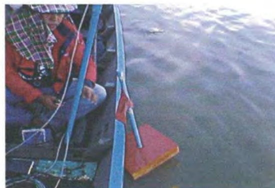
รูปที่ 3-14 ท่อนลอยสำหรับตรวจวัดกระแสน้ำและทิศทาง
