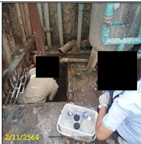
การเก็บน้ำตัวอย่างจากบ่อกักน้ำสุดท้าย ก่อนระบายออกสู่ท่อระบายน้ำสาธารณะ ริมถนนแนบเคหาสน์ ทางทิศใต้ของโครงการ เมื่อวันที่ 2 พฤศจิกายน 2564
