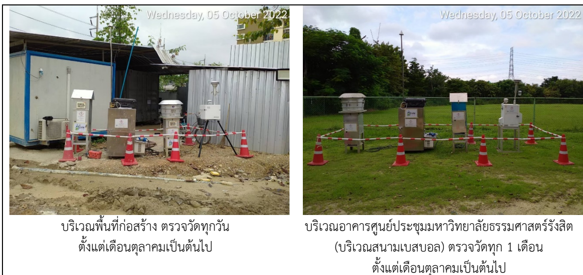
รูปที่ 3.1-2 ภาพถ่ายการเก็บตัวอย่างฝุ่นละอองและคุณภาพอากาศ ระหว่างเดือนกรกฎาคม-ธันวาคม 2565
