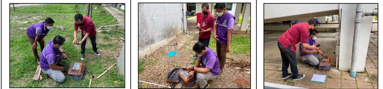
ภาพที่ ค-8 การตรวจสอบคุณภาพระบบกรวดทางไฟฟ้า ระหว่างเดือนกรกฎาคม – ธันวาคม 2565
