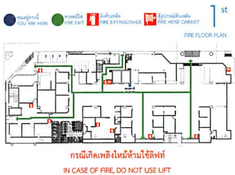
(ส) การติดตั้งแผนบอกตำแหน่งติดตั้งอุปกรณ์ดับเพลิง และทางหนีไฟ
