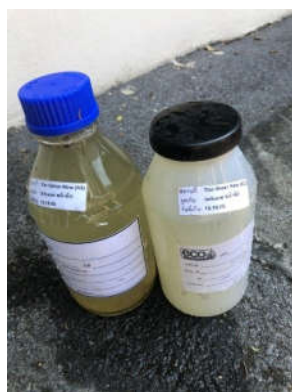
น้ำเสียก่อนเข้าระบบบำบัด (Influent) หลังอาคาร เอ 3
