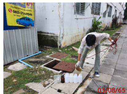
บ่อตรวจสอบภาพน้ำสุดท้าย (D) (จุดก่อนปล่อยออกสู่สาธารณะ)
