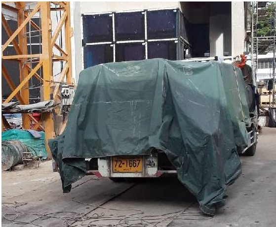
รูปที่ 2.9 การปิดคลุมรถบรรทุก
