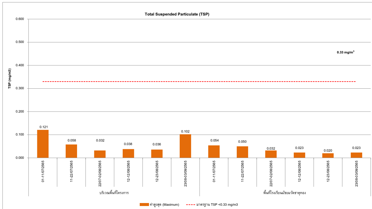
กราฟที่ 3.5-1 ผลการตรวจวัดฝุ่นละอองรวม หรือฝุ่นละอองขนาดไม่เกิน 100 ไมครอน (TSP) (ระยะฐานราก) ระหว่างเดือนกรกฎาคม - สิงหาคม พ.ศ.2565
