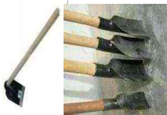
จอบ ใช้สำหรับเกลี่ยดินและ คอนกรีต
