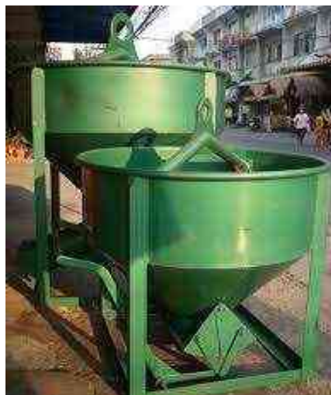
Pocket ใช้เทคอนกรีต ใช้แบบเปิดข้าง
