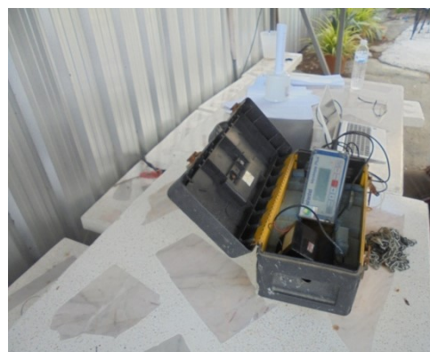
ภาพที่ 6 การติดตั้งเครื่องตรวจวัดคุณภาพสิ่งแวดล้อม และเก็บตัวอย่างน้ำทิ้ง (บริเวณด้านทิศตะวันตก และเครื่องตรวจวัดความสั่นสะเทือนขยับไปตามทิศทางการทำเสาเข็ม)
