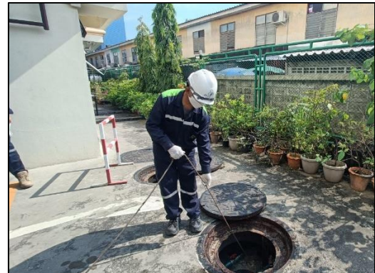
บ่อพักน้ำทิ้งที่ออกจากบ่อดักตะกอน (หลังผ่านการเติมคลอรีนแล้ว) ก่อนระบายออกนอกโครงการ
